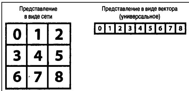
Рис. 2.1 ❖ Преобразование позиций из двумерного в одномерное представление
